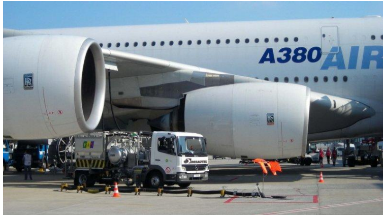
Figura 3.- Ejemplo del posicionamiento del vehículo y conos durante la recarga
