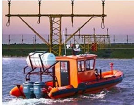
Figura 3. Tipo de bote con dos motores, balsas de salvamento y sistema de extinción
