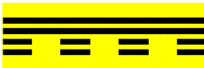
Figure 6. b. Letreros de límite de área de seguridad/OFZ y límites de área de pistas de aproximación
