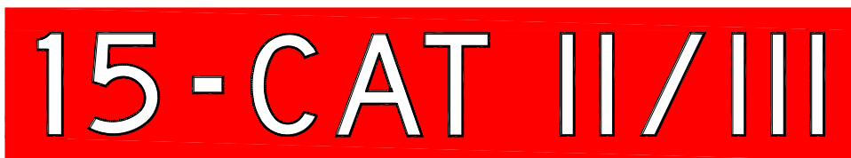
Figura 2. d. Letrero de Posición de Espera Operaciones CAT II/III
