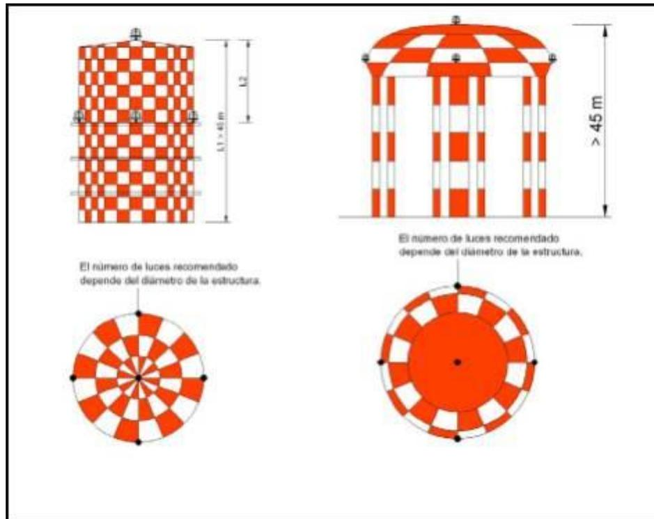
Figura 2-3-6. Ejemplos de iluminación de obstáculos/estructuras >45m
