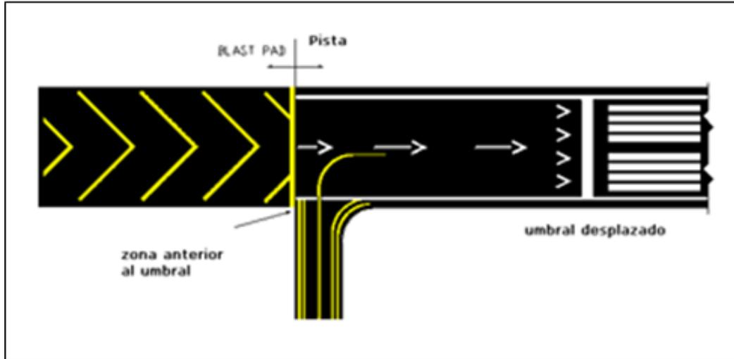
Figura 5-3-3. Señal anterior al umbral con umbral desplazado
