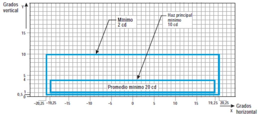
**Figura ADJB-16. Diagrama de isocandelas para luces de eje de calle de rodaje (espaciado de 7,5 m, 15 m, 30 m), de barra de prohibición de acceso y de barra de parada en tramos curvos previstas para ser utilizadas en condiciones de alcance visual en la pista de 350 m o superior**
