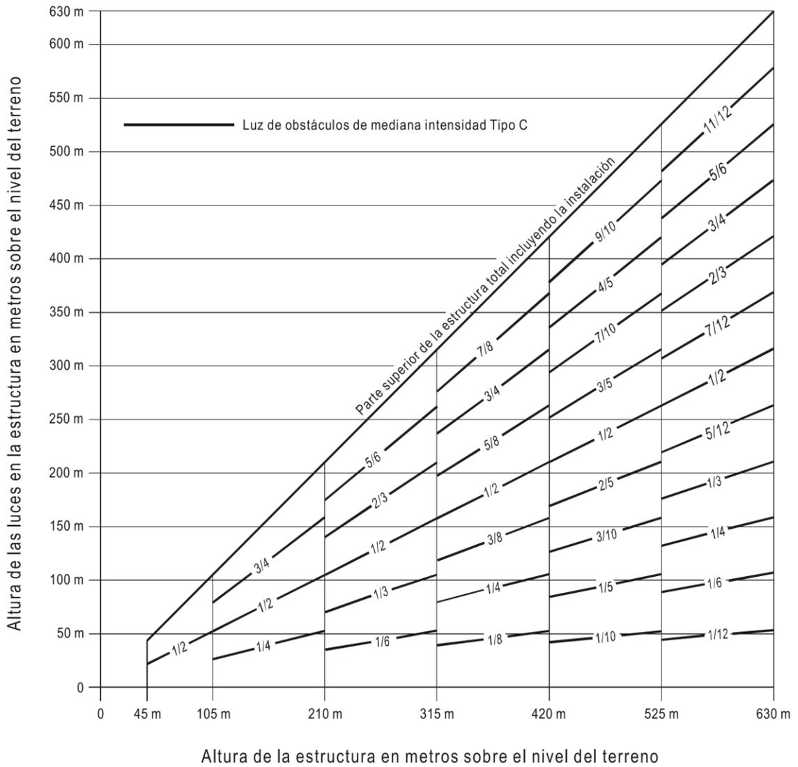
**Figura ADJA -3. Sistema de iluminación de obstáculos con luces rojas fijas de mediana intensidad de Tipo C**
