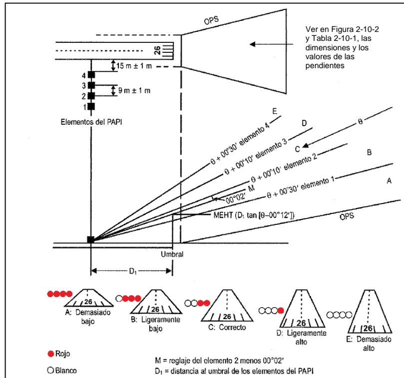
**Figura 1-10-4. Disposición de los elementos del PAPI**
