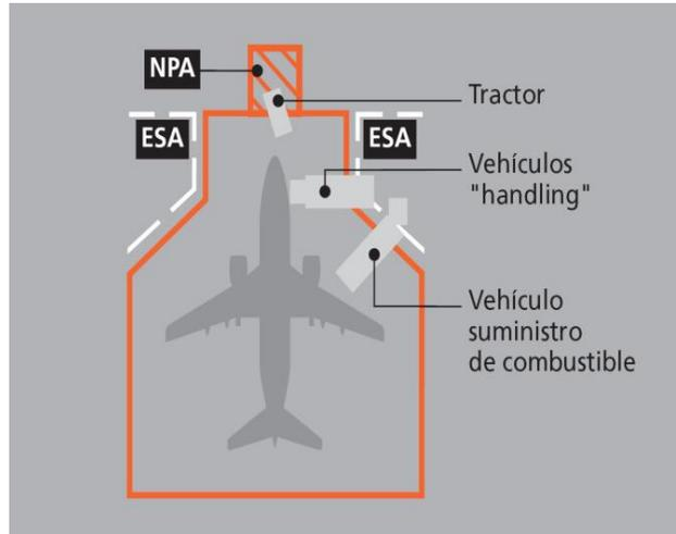
Figura 2-24-4. NPA delante del morro de la aeronave
