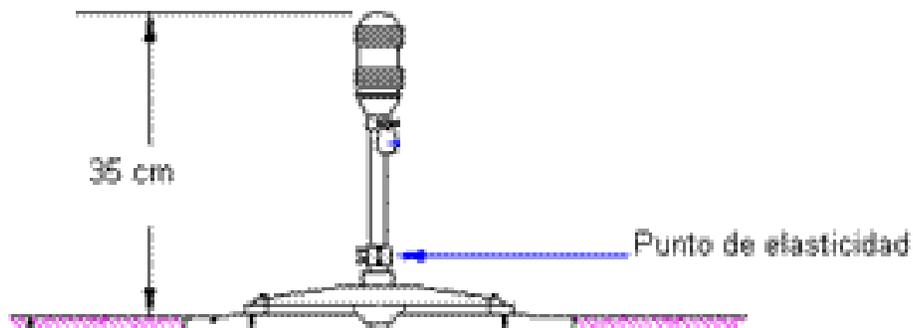
El punto de elasticidad no deberá estar a más de 38 mm sobre la superficie del suelo y debería ceder antes de que cualquier otra parte del dispositivo se vea dañado.
