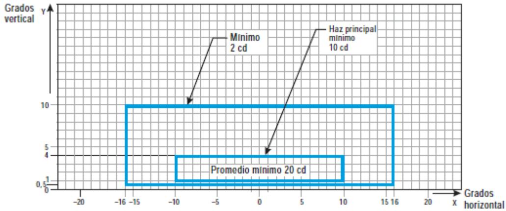
**Figura ADJB-15. Diagrama de isocandelas para luces de eje de calle de rodaje (espaciado de 30 m, 60 m), de barra de prohibición de acceso y de barra de parada en tramos rectos previstas para ser utilizadas en condiciones de alcance visual en la pista de 350 m o superior**
