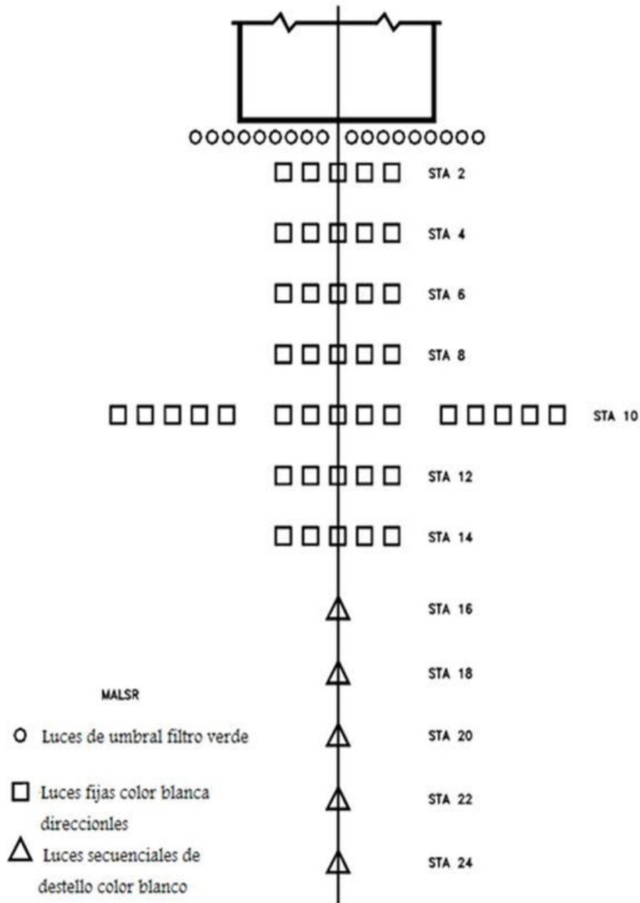
**Figura 1-6-1. Diagrama esquemático del Sistema MALSR CAT I**
