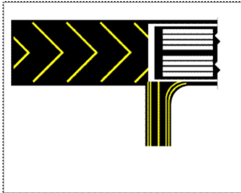
**Figura 5-3-2. Configuración de la Señal anterior al umbral**
