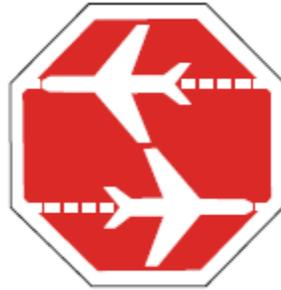
**Figura 4-1-2 Señal de detención alternativa para puntos de espera de una vía de vehículos que interseca una calle de rodaje.**
