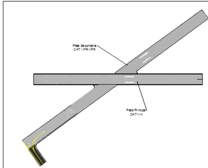
Figura 1-8-1. Ejemplo de interrupción de señales de pista
