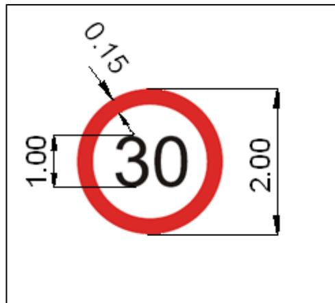
**Figura 4-1-4** Detalle de señales límite de velocidad
