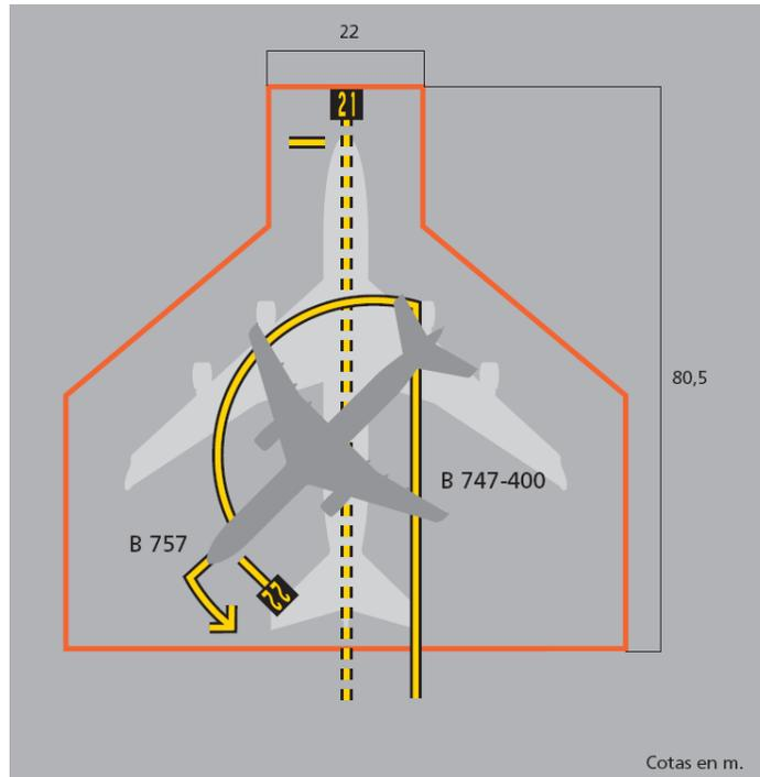
Figura 2-25-6. Estacionamientos superpuestos para distintos tipos de aeronaves.
