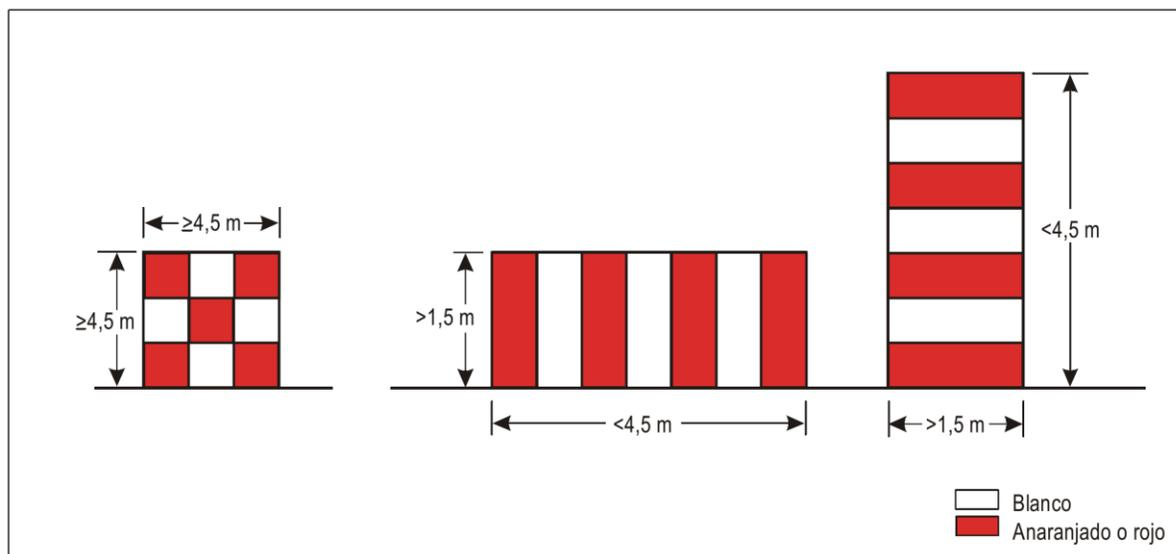
Figura 2-3-1. Configuraciones básicas de la señalización de obstáculos
