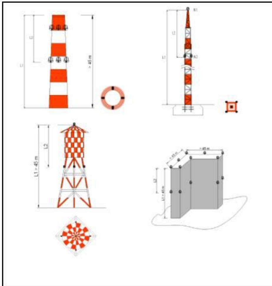
Figura 2-3-5. Ejemplos de iluminación de obstáculos/estructuras >45m
