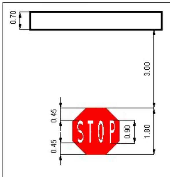
**Figura 4-1-1 Señal de detención. Características y emplazamiento**
