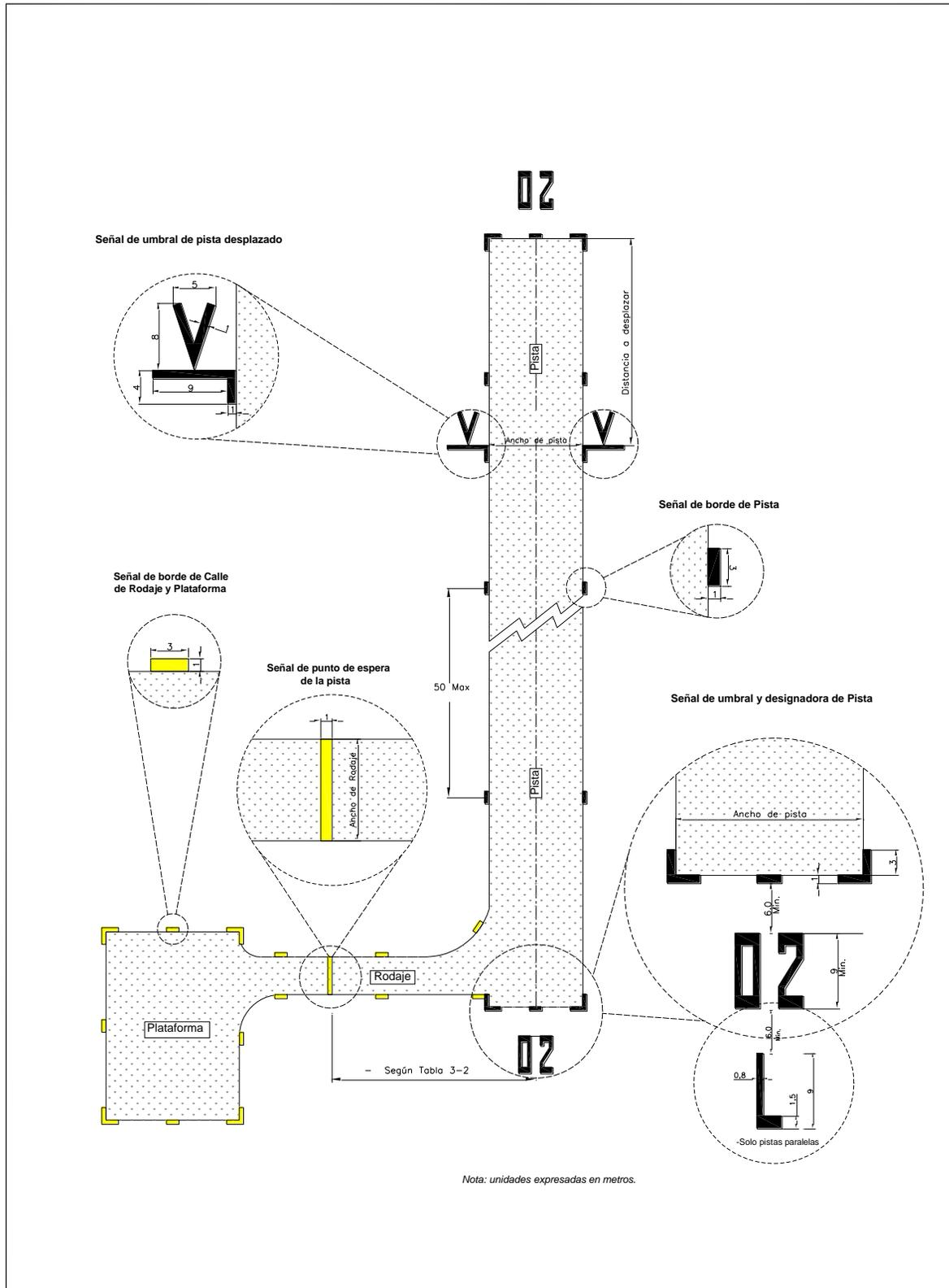
Figura 6-2-1. Configuración de señales para pistas no pavimentadas
