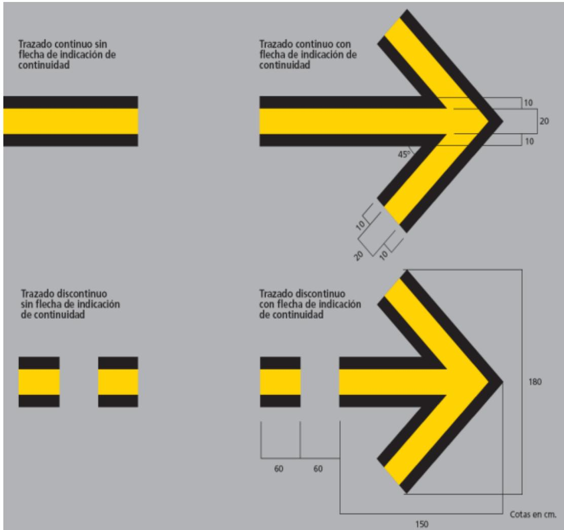
Figura 2-13-1. Señal de salida de puesto de estacionamiento
