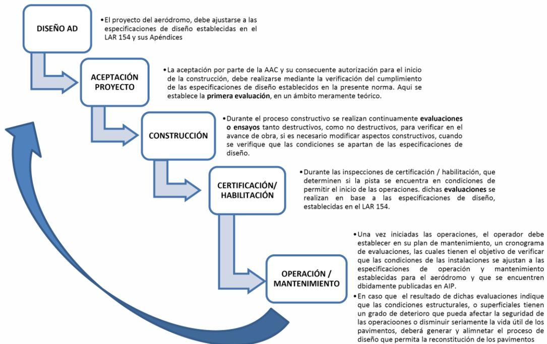
**Figura 1-1. Diagrama de vida de un pavimento**
