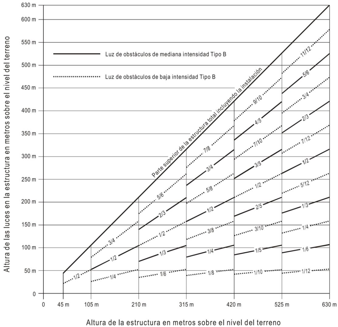
**Figura ADJA-2. Sistema de iluminación de obstáculos con luces rojas de destellos de mediana intensidad de Tipo B**
