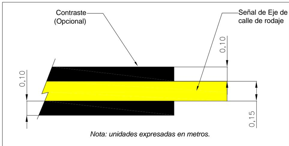
**Figura 3-1-3. Señal de eje de calle de rodaje - Detalle**
