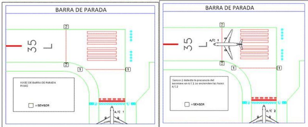
Figura 1-29-1. Luces de barra de parada accionadas por sensor
