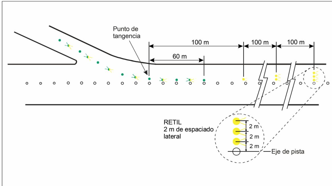
Figura 1-20-1. Luces indicadoras de calle de salida rápida (RETIL)
