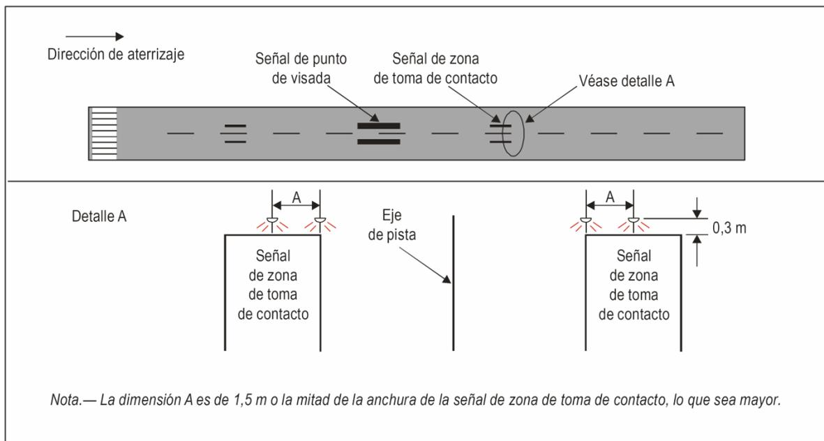
Figura 1-19-3 Luces simples de toma de contacto
