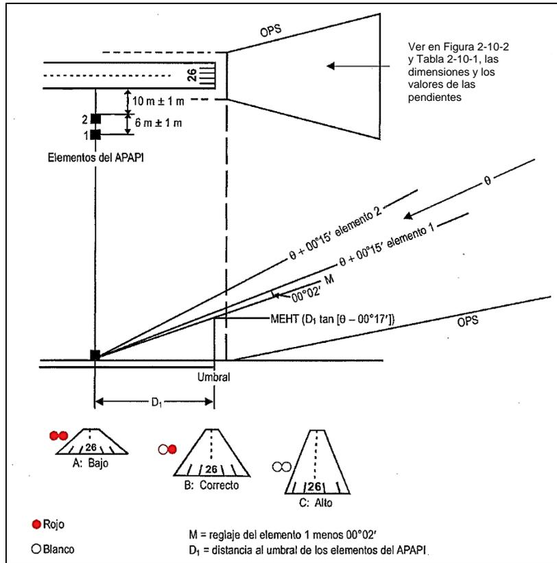
Figura 1-10-5. Disposición de los elementos del APAPI
