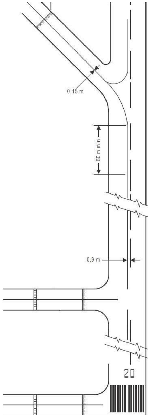
Figura 3-1-1. Señal de eje de calle de rodaje
