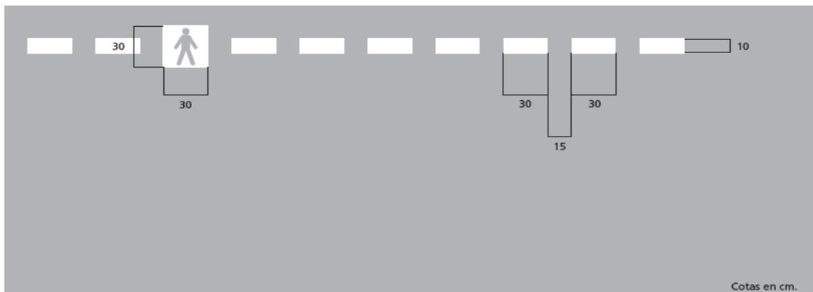
Figura 2-26-1. Señal de senda peatonal en Plataforma
