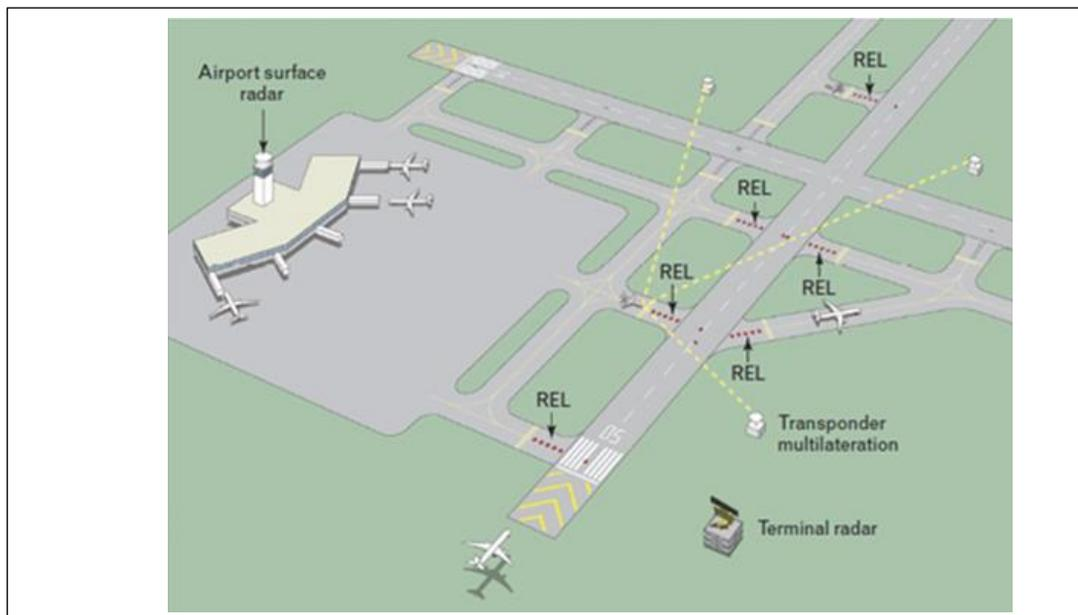
**Figura 1-41-1 Sistema autónomo de advertencia de incursión en la pista (ARIWS)
