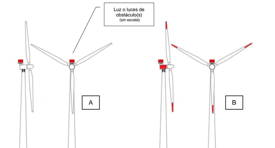
Figura 3-1. Señalización de turbinas eólicas
