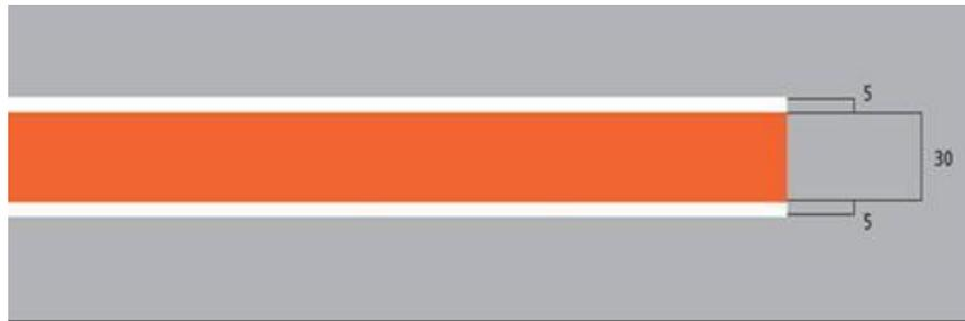
Figura 2-4-1. Línea de seguridad en plataforma ABL
