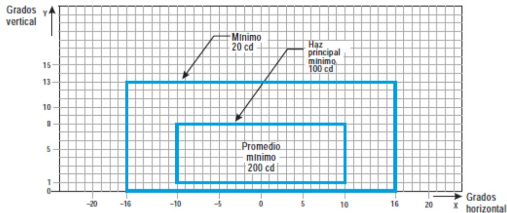
**Figura ADJB-12. Diagrama de isocandelas para luces de eje de calle de rodaje (espaciado de 15 m), REL, de barra de prohibición de acceso y de barra de parada en tramos rectos previstas para ser utilizadas en condiciones de alcance visual en la pista inferior a un valor de 350 m cuando pueda haber grandes desplazamientos y para luces de protección de pista de baja intensidad, configuración B.**
