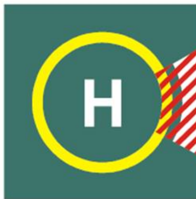
Figura A-5-10. Señal de sector de aterrizaje prohibido en la heliplataforma
