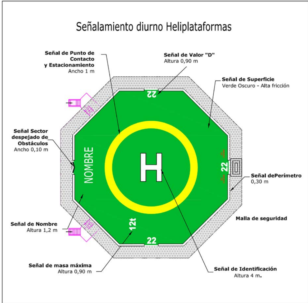
Figura A-5-8. Señalamiento de heliplatforma
